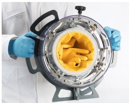
Le système STIC (Système de Transfert Interchangeable Consommable), permet la mise en place d'un élément interchangeable tel qu'un gant, un sac, un obturateur, un soufflet ou autre accessoire d'une Bague Support (BS), tout en gardant l'étanchéité avec la Bague d'Enceinte (BE), elle-même fixée de manière étanche sur l'enceinte de confinement.
