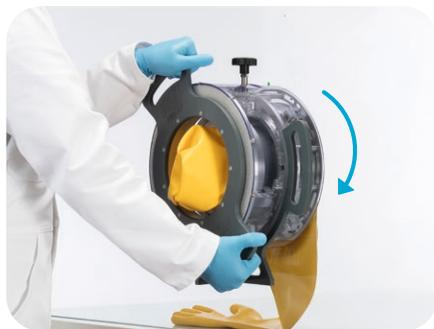
4 • Remplacer la BS en tournant le volant en sens horaire à l'aide des poignées jusqu'à la butée. La BE et son accessoire usagé sont éjectés dans la boîte à gants. La nouvelle BS est immobilisée.
