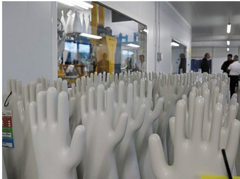
Le visiteur est accueilli dans la nouvelle unité de production de Piercan par un spectacle bien étonnant : une forêt de bras en porcelaine : les moules pour la fabrication de gants isolants.
